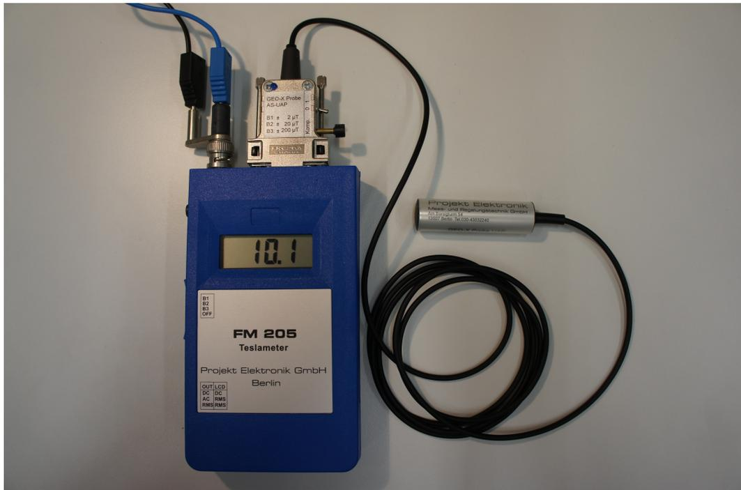
Abbildung 5.15: Teslameter mit Geo-Axialsonde zur Bestimmung des Erdmagnetfelds.
